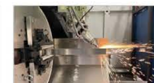
Groove cutting 坡口切割
